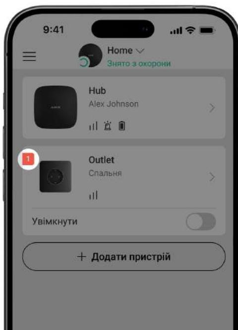
Якщо система виявляє несправність Outlet [type F], на іконці пристрою в застосунку Ajax з'являється лічильник несправностей. Усі несправності можна переглянути у станах розетки — відповідні поля мають червоний колір.
