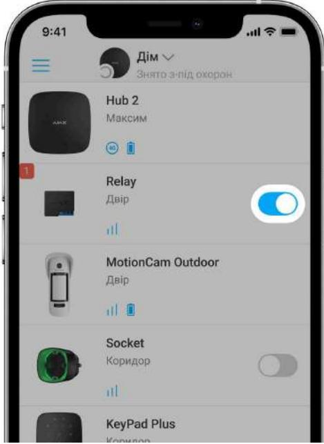
У застосунках Аjaх можна вмикати та вимикати електроприлади, якщо вони підключені до електричного кола, яким керує Relay.
