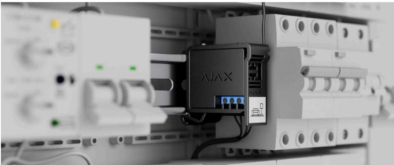
Relay розміром 39×33×18 мм під'єднується в розрив електричного кола. Завдяки розмірам Relay, його можна розмістити в поглиблениму підрозетнику, корпусі електроприладу або електричному розподільному щиті. Гнучка зовнішня антена забезпечує стабільність зв'язку. Для встановлення Relay на DIN-рейці рекомендуємо використовувати [DIN Holder](#).
