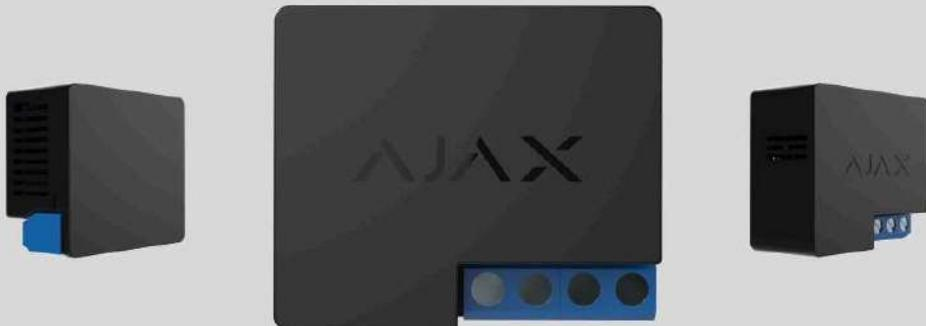
**Relay** – це реле з безпотенційним «сухим» контактом для дистанційного керування електроприладами. Реле оснащено сухим контактом, який гальванічно не пов'язаний із електричним колом живлення пристрою. Це дає змогу використовувати Relay як у низьковольтних, так і в побутових електромережах. Пристрій забезпечений двома видами захисту: за напругою живлення та температурою.
